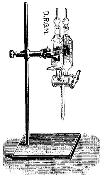
Verengungen der Meßpipetten sind Glasschwimmer angebracht, welche nach der Füllung ein Übersteigen der Flüssigkeit verhindern.
